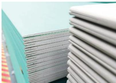
Les matériaux de doublage sont souvent constitués de matières sensibles (plaques de plâtre...). Lors de la réfection de l'isolation intérieure, il est également conseillé d'utiliser les ossatures métalliques inoxydables pour créer la structure, plutôt que les plaques collables.
