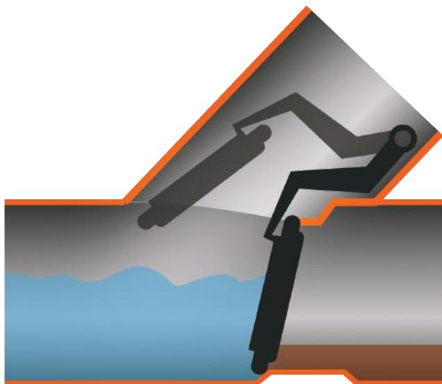
Les eaux de la submersion peuvent refouler par les réseaux et remontant dans les tuyaux remplir les parties basses des habitations d'eaux usées. Un clapet posé à la sortie de l'évacuation du logement **empêchera tout mauvais retour issu du réseau urbain.**
